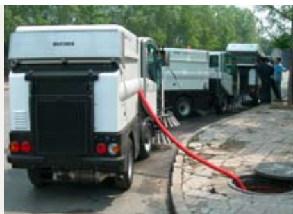
Водяные баки подметальных машин наполняются непосредственно от водяных гидрантов города.
